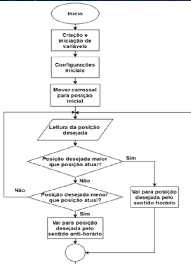
Figura 4 – Fluxograma do algoritmo implementado no carrossel
