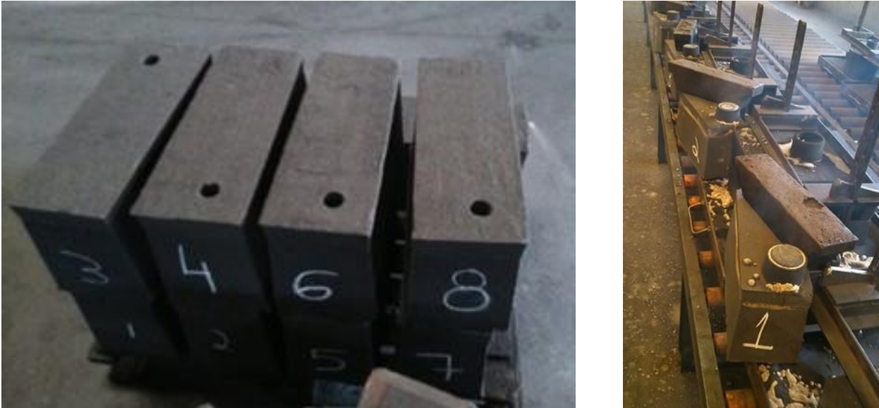
Figura 2- À esquerda, moldes dos corpos de prova produzidos. À direita, blocos dos corpos de prova preenchidos com ferro fundido nodular.
