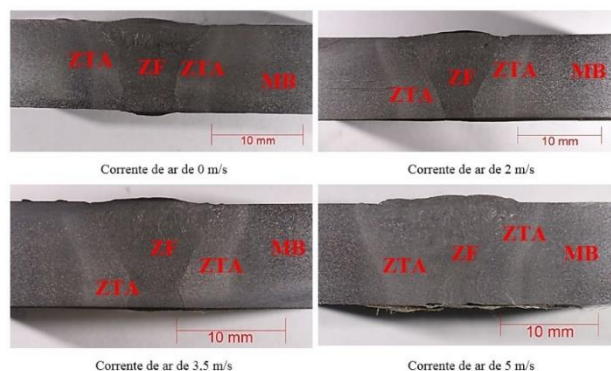
Figura 1 - Macrografia dos cordões realizados em diferentes velocidades de correntes de ar. Ataque Nital 7%.
