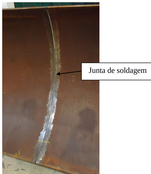
Figura 2 – Posicionamento das chapas calandradas para a soldagem. Fonte: próprios autores.
