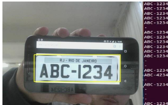
Figura 11: Observa-se na esquerda, o software identificando a placa no vídeo, e à direita, o resultado da leitura dos caracteres.
